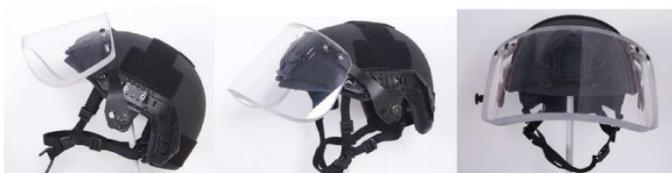
A viseira balística VIS35 com nível de proteção balística NIJ IIIA de acordo com o padrão 0.106.1 de múltiplos impactos foi projetada para ser compatível com capacetes balísticos que possuem trilhos laterais picatinny, permitindo assim que seja colocada e retirada rapidamente e sem a necessidade de ferramentas.
