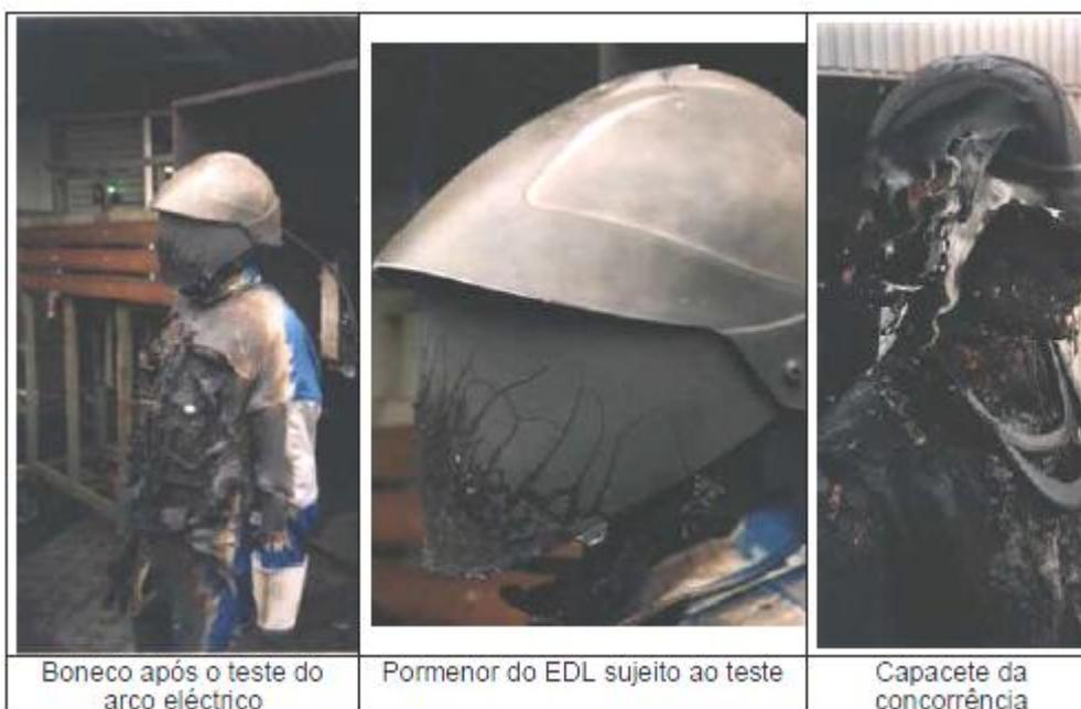
Boneco após o teste do arco eléctrico
